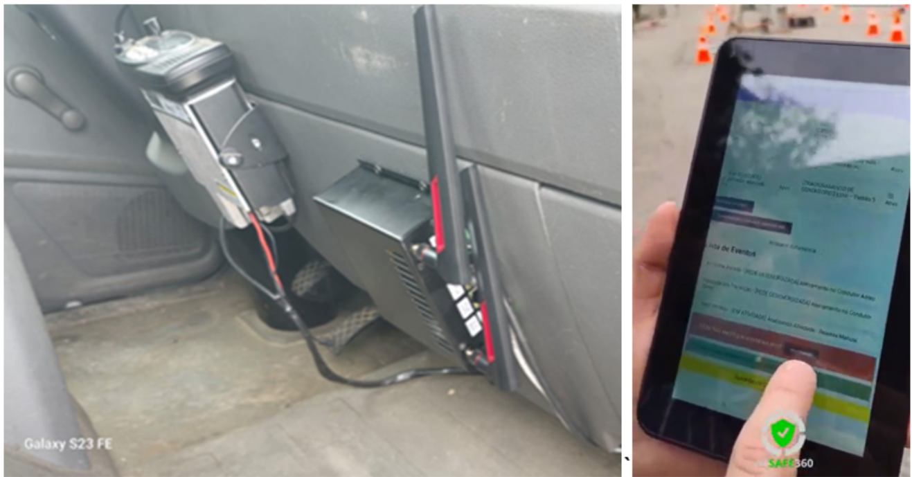
Figura 4 – Módulo embarcado móvel instalado em veículo (esquerda) e tablet (direita) com IHM para o eletricista desenvolvida no projeto harplA
